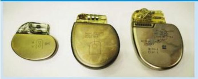
Obr. 2: Rôzne typy srdcových implantovateľných elektronických prístrojov, záva doprava dvojdiutinový kardiostimulátor, jednodutinový kardioverter defibrilátor a biventrikulárny kardioverter defibrilátor
