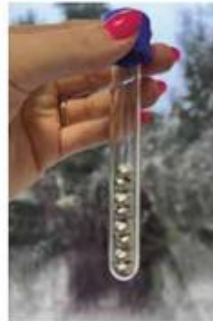
Obr. 5: Zliatina (TiVNB)85Cr15 v tvare 3 g bochníkov: pripravená na praškovanie a výskum absorpcie vodíka
