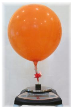
Obr. 1. a) Znáznornenie sústavy balón- závažie –digitálne váhy; b) Graf závislosti konečnej rýchlosti v_k pádu balóna od druhej odmocniny príslušnej hodnoty hmotnosti balóna.
