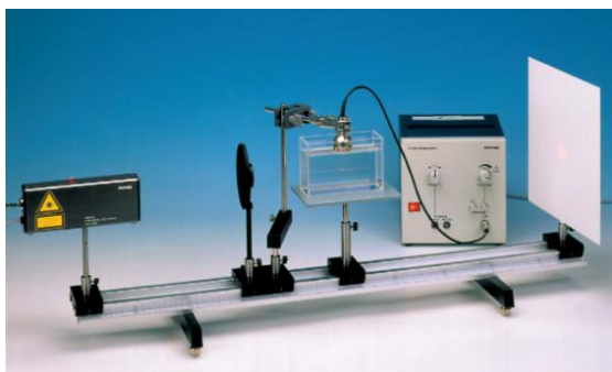
Obr. 1. Aparatúra pre meranie rýchlosti zvuku v kvapalinách (bez senzora pre záznam pozície a intenzity osvetlenia), vpravo výsledok merania pre destilovanú vodu v programe Logger Pro 3.8.6, výrazné difrakčné maximá umožňujúce presné určenie ich polohy a vzájomnej vzdialenosti
