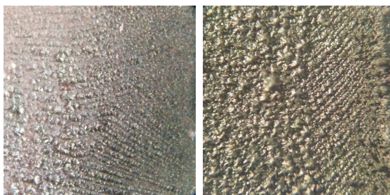
Obr. 1. Mikrosnímky polypyrolu vylúčeného z roztoku s koncentráciou 0,5 M Py pri pH 3,3 po 10 cykloch s rýchlosťou scanu 0,02 V/s, vpravo bez prídavku nanotrubičiek, vľavo s prídavkom nanotrubičiek
