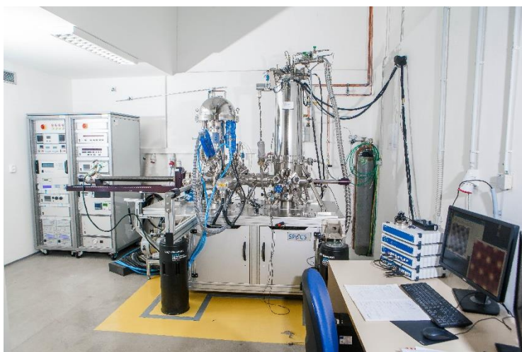
Obr. 3: Náš kryogénny skenovací tunelový mikroskop v ultravysokom vákuu.
