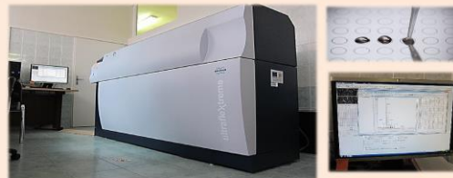
Bruker Ultraflex extreme, MALDI TOF-TOF hmotnostný spektrometer - jeden z prístrojov ústavu
